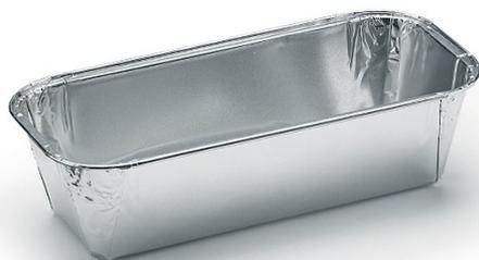
I contenitori in alluminio nudo possono essere utilizzati nell'intervallo di temperatura -40/+350°C; evitarne l'utilizzo con alimenti fortemente acidi o fortemente salati con valori di pH inferiore a 4 o superiore a 9. L'utilizzatore deve sempre eseguire un test di confezionamento per determinarne la durata e la funzionalità esatte.
